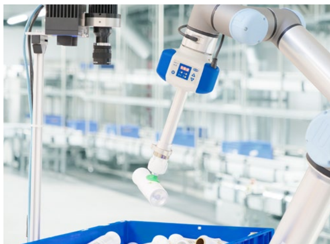
Vision & Handling-Set 3D-R mit statisch installiertem Kamerasystem für die Entnahme von Spraydosen aus einer Kiste
